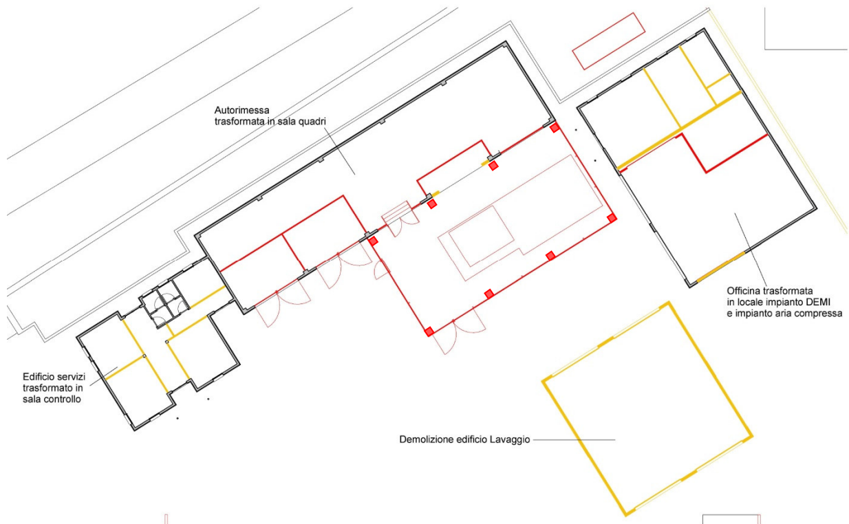
Figura 30 Planimetria con i principali interventi di demolizione e recupero degli edifici esistenti
