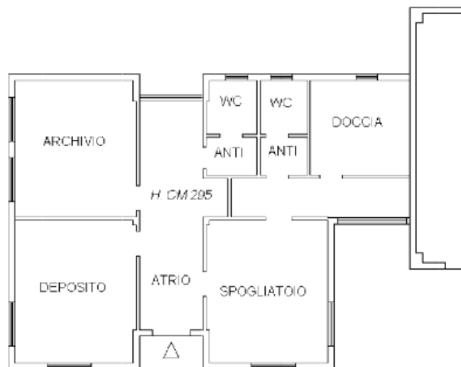
Figura 59 Planimetria Edificio Servizi – stato attuale
