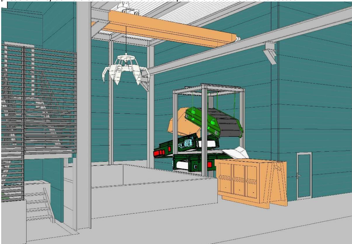
Figura 20 Dettaglio carro ponte fossa scorie
