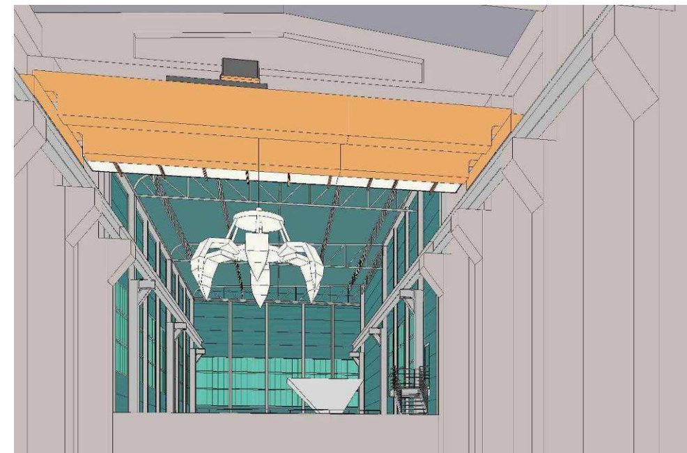
Figura 11 Dettaglio carroponte zona alimentazione combustibile
