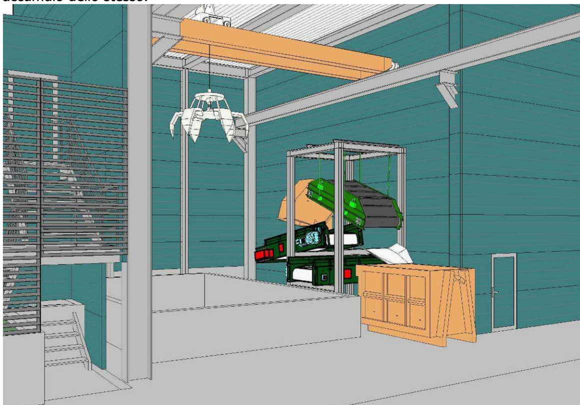
Figura 13 Dettaglio carro ponte fossa scorie
