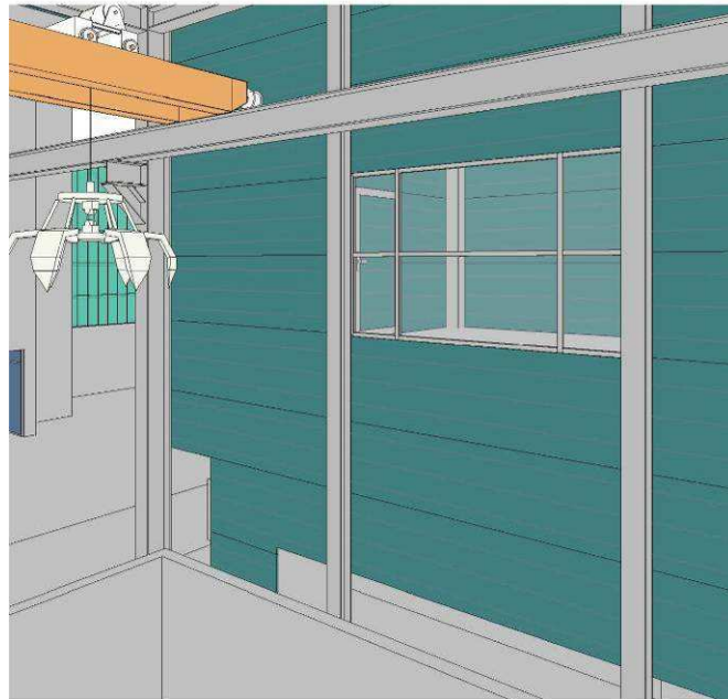
Figura 10 Dettaglio locale gruista, lato fossa, con vetri antisfondamento e di sicurezza dalla fossa scorie
