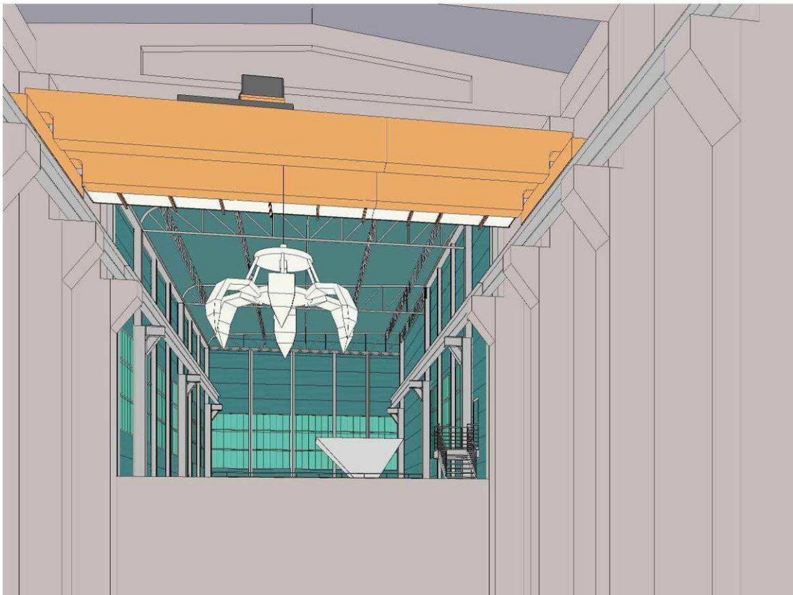
Figura 8 Vista del sistema di alimentazione dei rifiuti
