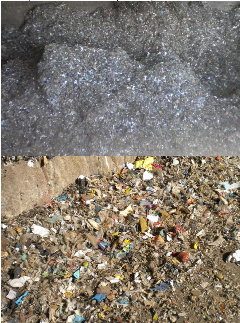
Figura 3 Immagini del CSS nella fossa rifiuti dell'impianto
