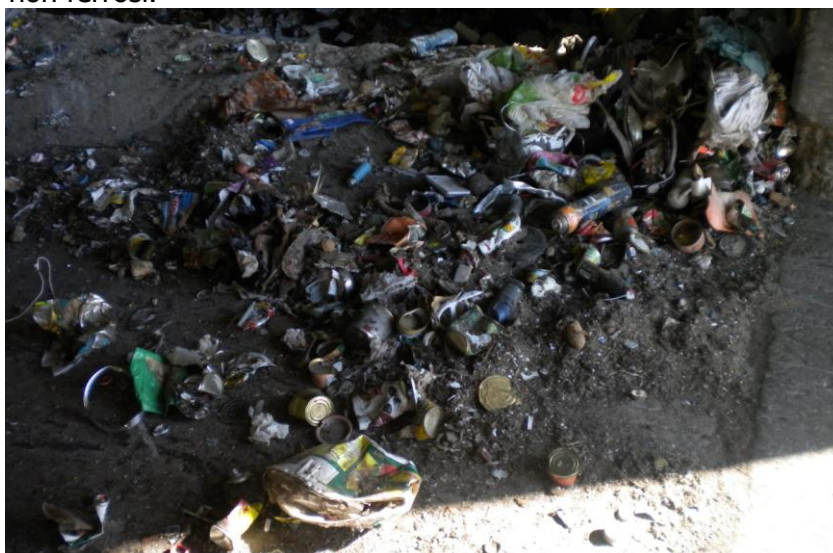
Foto 2 Scarti medio/pesanti del separatore aerulico in data 09/10/2012 rilevati in impianto
