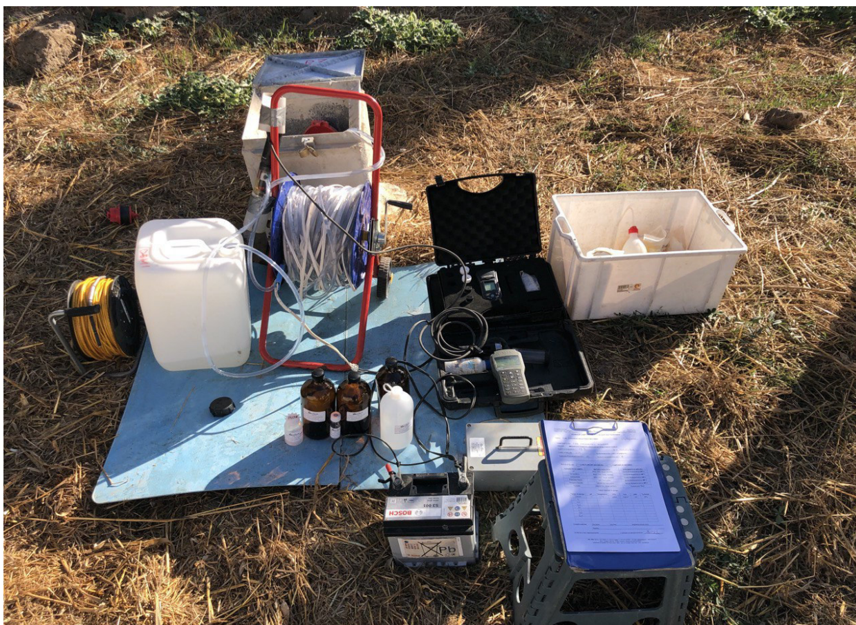
Fig.4 : Fotografia campionamento piezometro PZ-3 interno al complesso industriale
