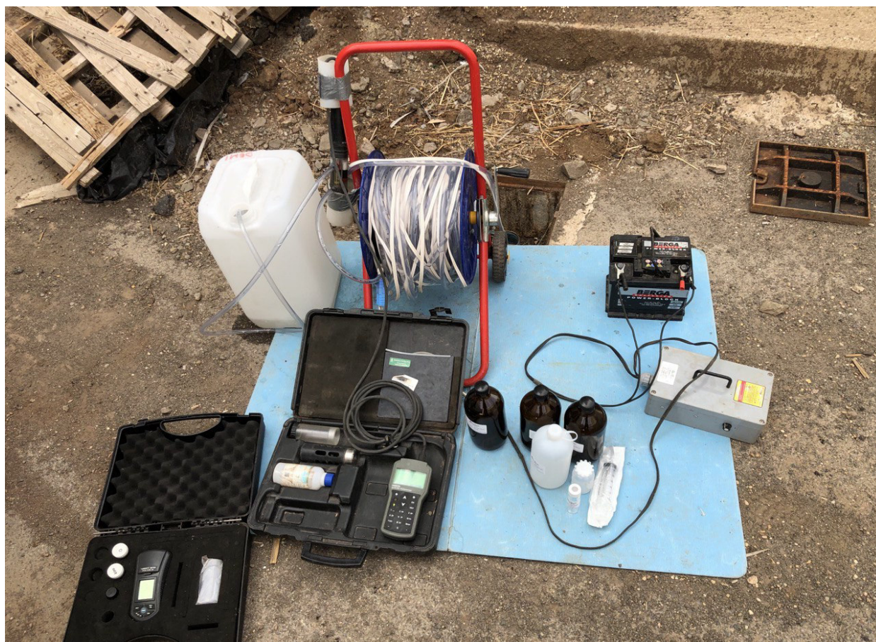
Fig.6 : Fotografia campionamento piezometro PZ-5 interno al complesso industriale
