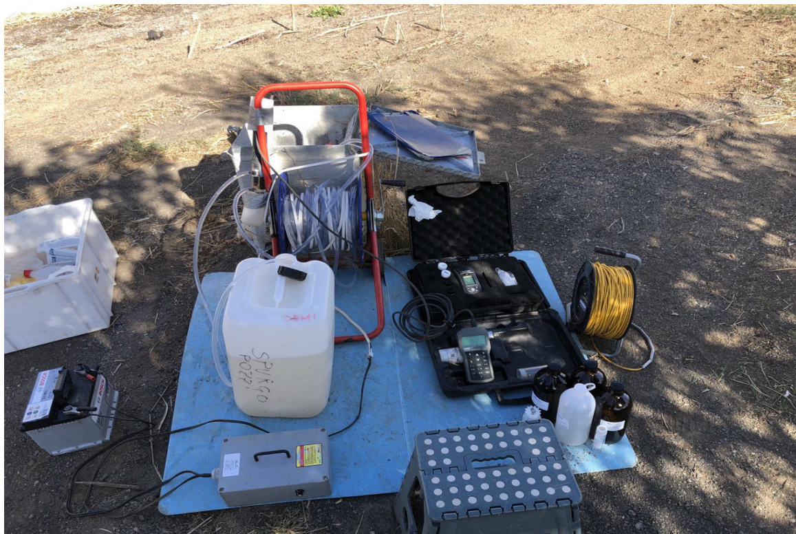
Fig.12 : Fotografia campionamento piezometro PZ-A interno al complesso industriale
