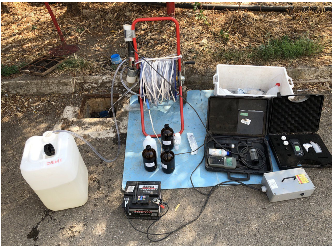
Fig.9 : Fotografia campionamento piezometro PZ-8 interno al complesso industriale
