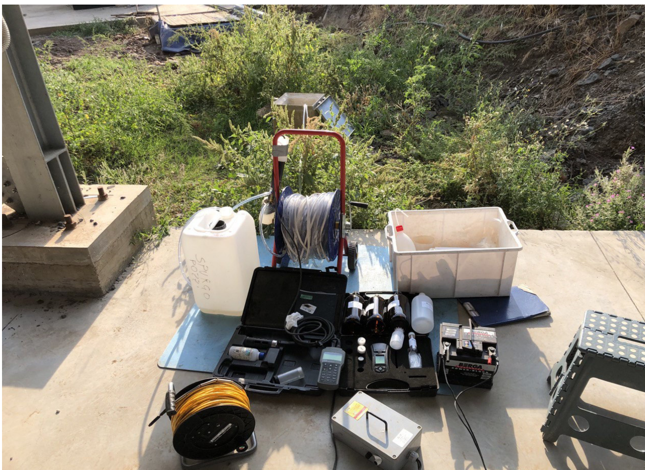
Fig.11 : Fotografia campionamento piezometro PZ-10 interno al complesso industriale
