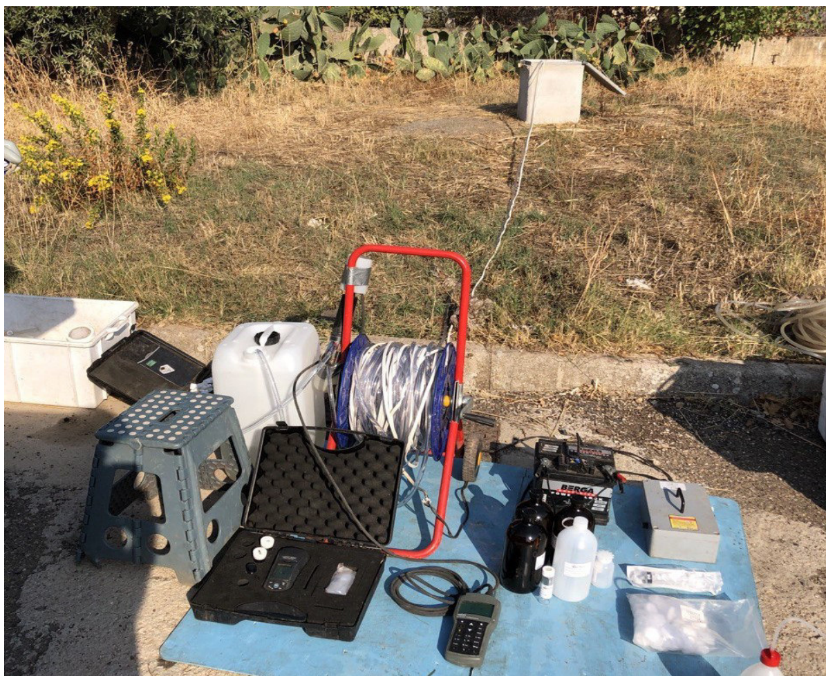
Fig.5 : Fotografia campionamento piezometro PZ-4 interno al complesso industriale
